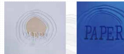
註：左圖為左圖紙張於紫外線燈照射下所拍攝之照片。其中「PAPER」字樣由無螢光紙剪裁而成，外圍則由有螢光劑的紙張堆疊而成。在紫外線燈照射下可明顯看出有添加螢光劑與無添加螢光劑紙張的差異。
