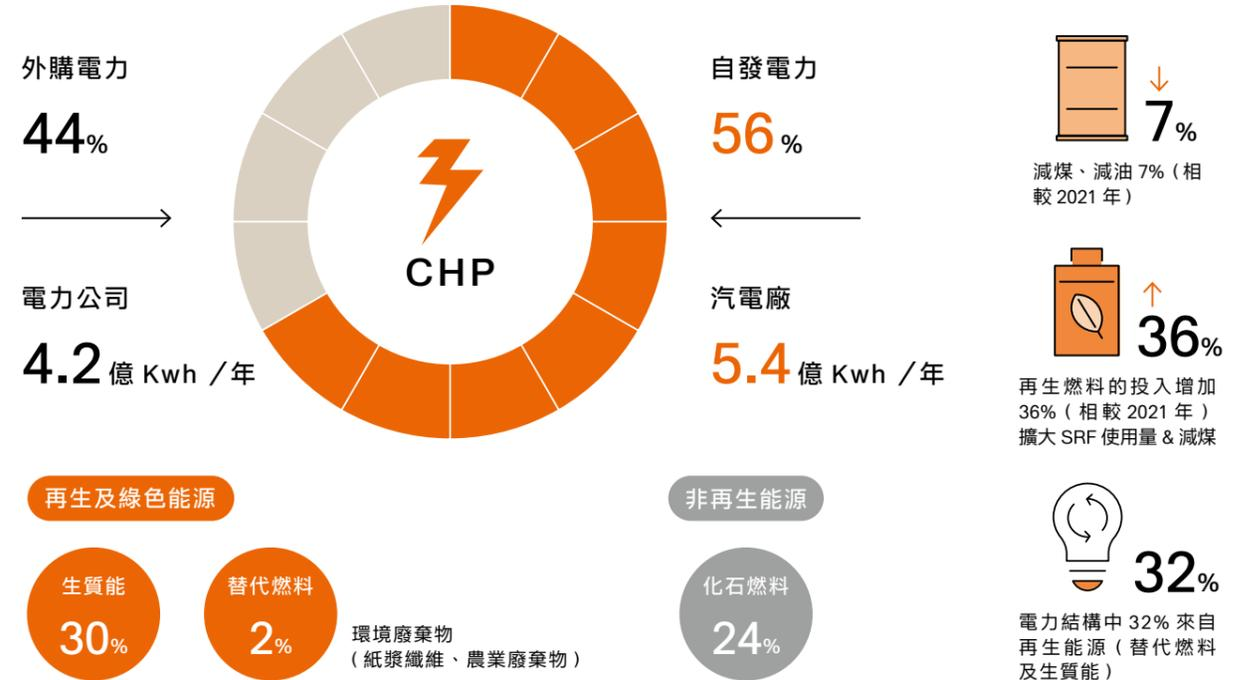
華紙的動力來源主要利用汽電共生系統 (Cogeneration System)，自行供應營運 50~90% 電力，離峰時段還可以回饋電力平衡區域用電的壓力。汽電共生有熱能與電能兩者聯產之特性，相較於傳統發電系統，餘熱無法再利用，會以廢熱形式排入大氣中。汽電共生系統投入的燃料成本，可同時獲得電力及有效熱能兩種效益，達到減少廢熱排放、提升能源利用率及降低化石燃料用的使用。華紙的汽電共生系統熱值來源有煤、生質能、漿紙汙泥、回收塑膠混合物等，透過合理化的電能分配，得以有效使用能源。
