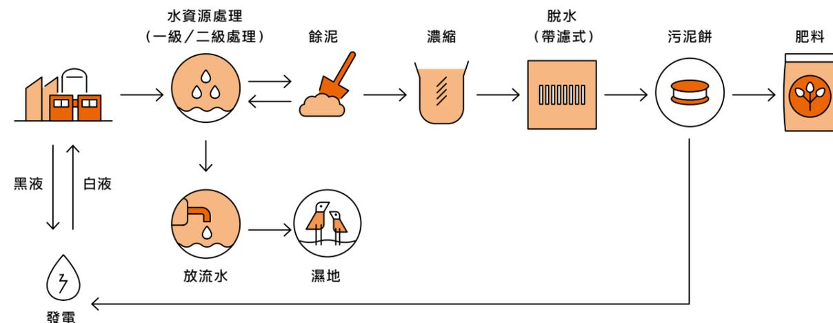
水質的管理從製程用水、操作單元排放水開始建立預警管理機制，對於每一條產線進行排放水質管控，讓所有進水處理廠前的製程廢水都在監控下，預防超過處理系統的負荷量。確保處理後出廠的水質符合規範，此外，我們以領先業界的的管理，當管制站發現製程排放水質異常時，透過警示系統通知相關單位管理人員即時處理，嚴重時可以緊急停機。近年來，受氣候變遷愈趨劇
