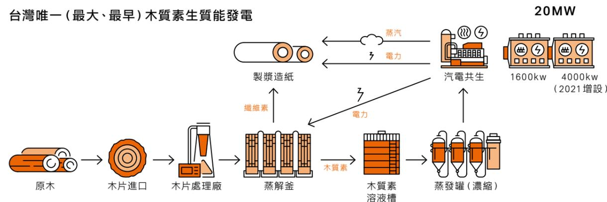
華紙生產紙漿的過程是將木材蒸煮讓木材纖維分離生產紙漿和紙，溶出的液體主要為木質素 (俗稱黑液)。溶液中包含木質素、木材精油、果膠質、澱粉、半纖維素、少量的纖維素等有機質，經蒸發罐濃縮至 63~70% 的高濃木質素，輸送回收鍋爐燃燒，取代重油產生蒸汽，再經汽電共生系統提供製程蒸汽及電力。華紙生質能發電燃燒所產生之氣體排放亦透過完整管理措施，經過集塵設備，以避免受到空氣中汙染物之影響。受國際原物料價格波動影響，生質燃料有可能受到採購及財務管理風險。
